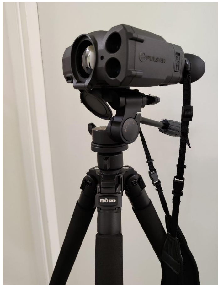
Slika 2-5 Termovizijska kamera Accolade LRF XP50 na stativu
