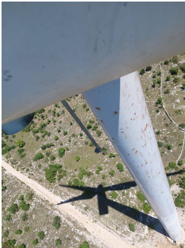
Slika 2-3 Mikrofon ultrazvučnog detektora Elekon BATLOGGER WE X2 postavljen ispod gondole (Fotografije: Vjetroelektrana Jelinak d.o.o.)
