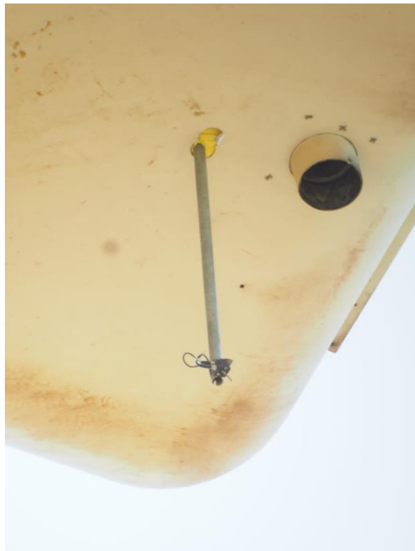
Slika 2-3 Mikrofon ultrazvučnog detektora Elekon BATLOGGER WE X2 postavljen ispod gondole (Fotografije: Vjetroelektrana Jelinak d.o.o.)
