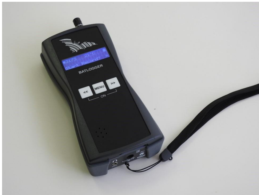
Slika 2-4. Ultrazvučni detektor Elekon BATLOGGER M
