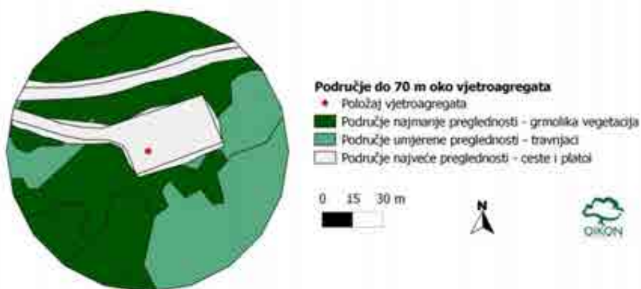
Slika 6. Primjer kartografskog prikaza preglednosti (postotka istraženosti) područja do 70 m oko vjetroagregata (bijelo-80-100%, svijetlo zeleno:40-80%, tamno zeleno: <40% istraženosti)
