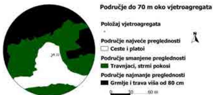
Slika 7. Primjer kartografskog prikaza preglednosti područja do 70 m oko vjetroagregata u svrhu pronalaska eventualno stradalih ptica i šišmiša
